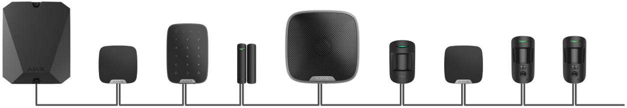
**Die Verbindung in einer Ringtopologie** belegt zwei Busausgänge der Hub-Zentrale. Sollte der Ring unterbrochen werden, wird kein einziges Gerät deaktiviert. Stattdessen werden zwei Linien gebildet, die den normalen Betrieb aufrechterhalten. Die Benutzer und das Sicherheitsunternehmen erhalten eine Benachrichtigung über die Leitungsunterbrechung.
